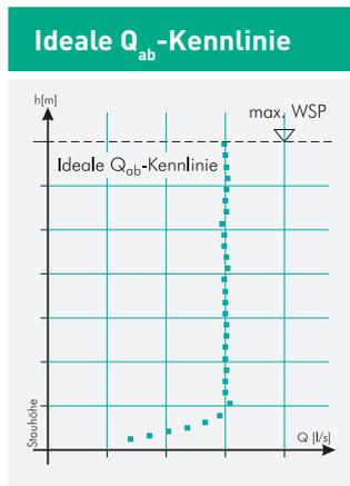
Senkrechte Q/h-Linien sind Standard, da ansonsten zusätzlich teures Speichervolumen vorgehalten werden muss. Heutige Kanalnetze sind auf Grund der Simulationsprogramme ausgereizt. Steinhardt Abflussregler arbeiten auch unter diesen schwierigsten Umständen sicher!
