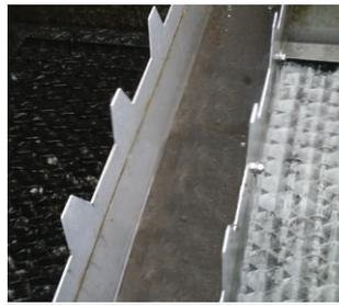
HydroM.E.S.I Typ STATIC mit Wabenstruktur – links mit Sediment – rechts nach der Reinigung
