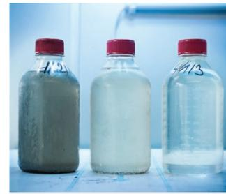
Reinigungsergebnisse: Links – ungereinigt Mitte – HydroM.E.S.I Typ STATIC Rechts – zusätzliche Filtration
