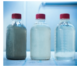
Beprobung des HydroM.E.S.I.®: Links: Zulauf Mitte: Ablauf nach Behandlung mit HydroM.E.S.I.® Rechts: Ablauf nach zusätzlicher Filtration
