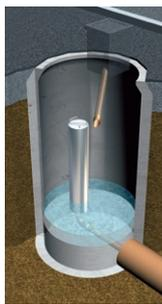
Mechanisch vorgereinigtes Wasser fließt in den Spülschacht. Der Wasserspiegel steigt. Ein beweglicher Überlauf schwimmt im **HydroFlush® Kanalspüler Typ SH** auf. Erst wenn der Wasserspiegel den Deckel erreicht, fällt intern Wasser über und startet die Heberwirkung. Der Spülschacht entleert sich durch den Spülheber, bis der **HydroFlush® Kanalspüler** Luft zieht. Das in dem Rohr anstehende
